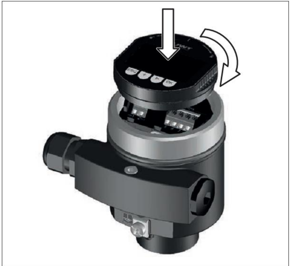
Rys. 14: Instalacja przenośnego modułu z wyświetlaczem w komorze elektroniki urządzenia w obudowie jednokomorowej
