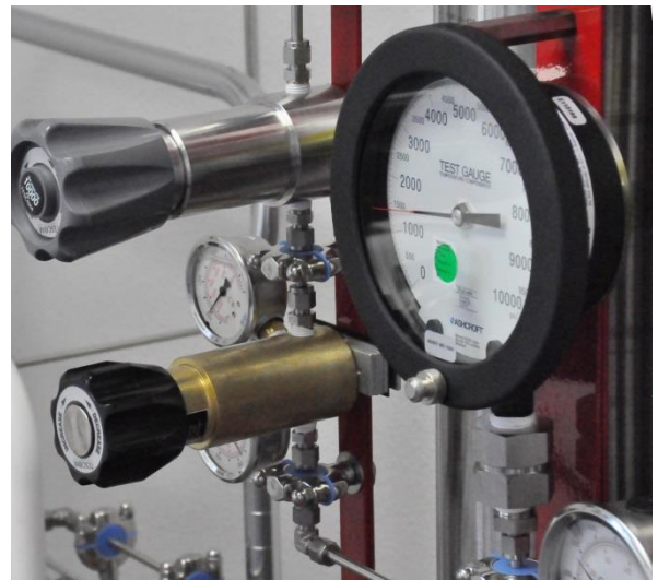
Manometr do zbiornika wysokiego ciśnienia używany podczas kalibracji
