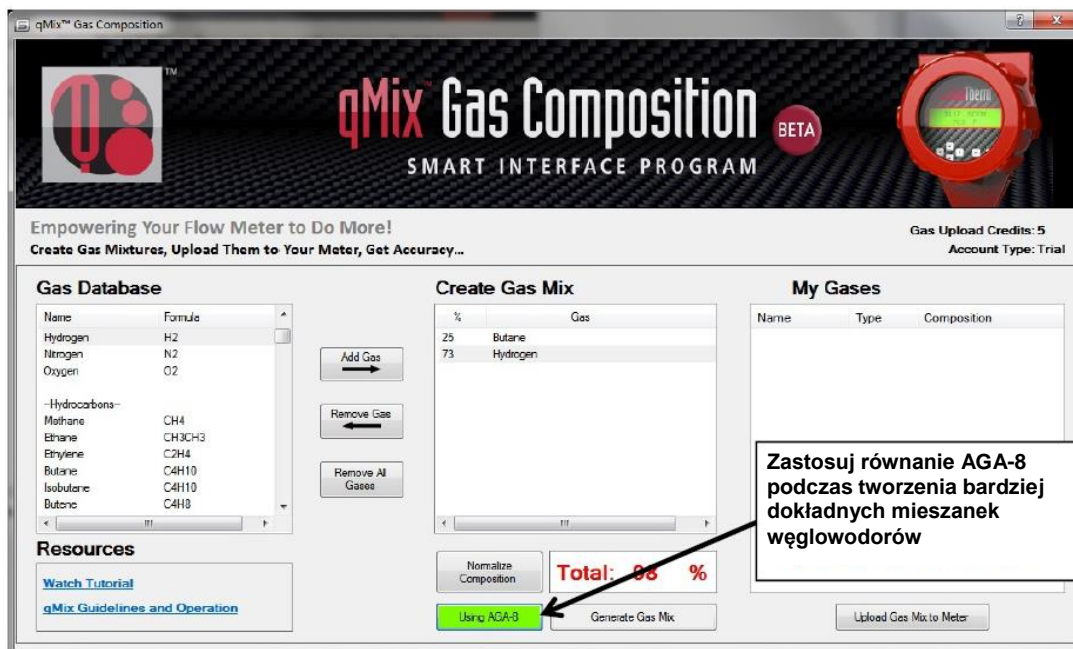
Rys. 7 Stosowanie równania stanu AGA-8 dla większej dokładności mieszanek węglowodorów
